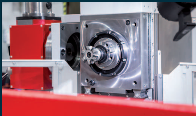
Váltás vízszintes marásra. DIN 69871 szerinti SK 40-es vízszintes maróorsó
