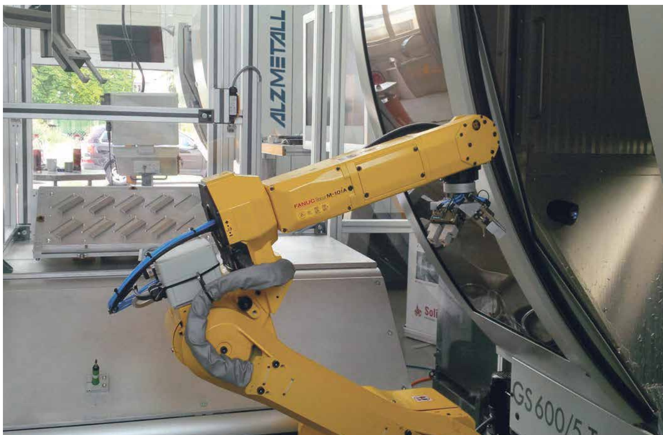
ALZMETALL GS 600/5-T és WU RZ-3/20 robotcella telepítése speciális alkatrészmozgatáshoz. A behelyezett megfogótól függően 20 kg-os mozgatott súly.
