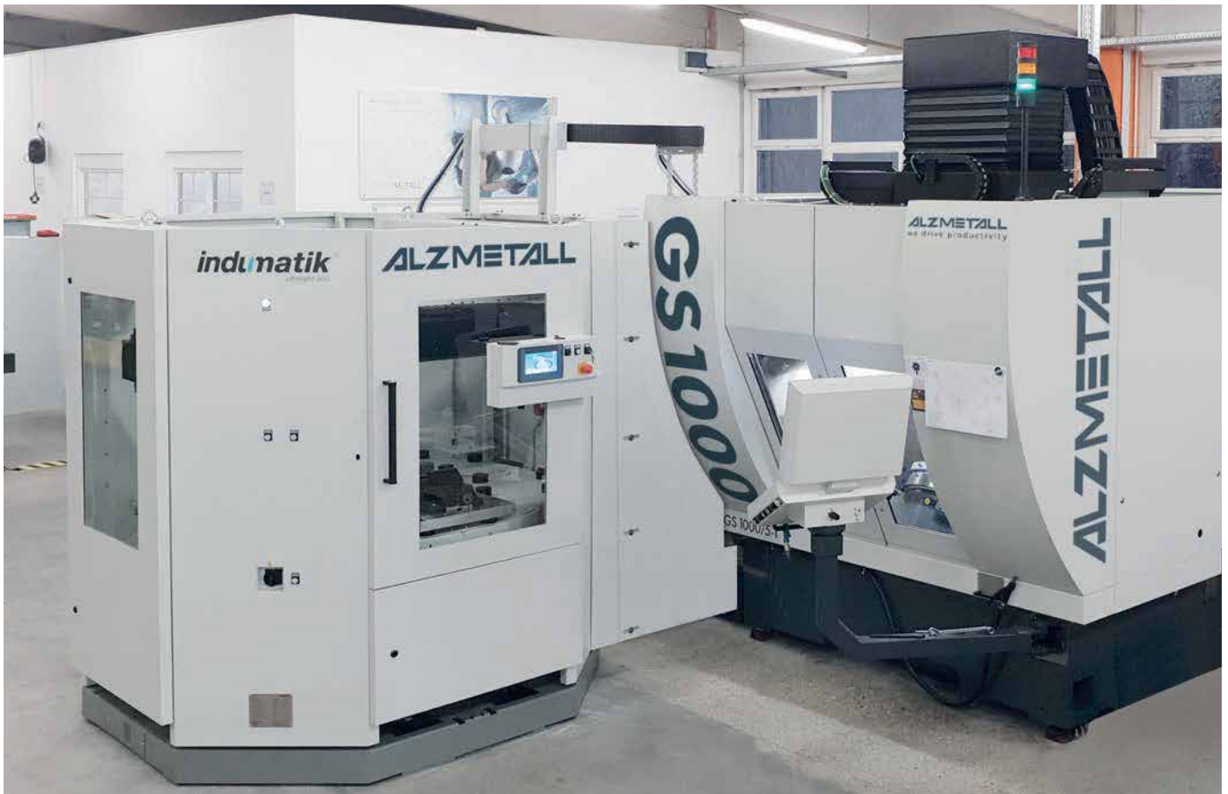
ALZMETALL GS 1000 és INDUMATIK Ultralight 300 telepítés. Mozcgatott súly max. 300 kg, 3–12 palettahely, palettaméret 320 x 320 mm-től 630 x 630 mm-ig. Tároló vezérlő egység a könnyű kezelői hozzáféréshez.
