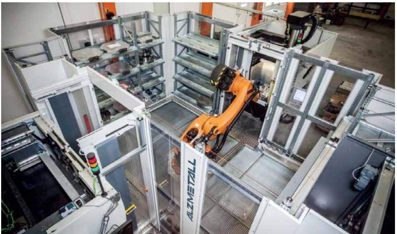
Rugalmas gyártócella ALZMETALL GS 1000 és GS 800 géppel. Mozcgatott súly max. 400 kg, 28 munkadarabpaletta, két palettához, méretek: 470 x 470 mm és 700 x 700 mm.
